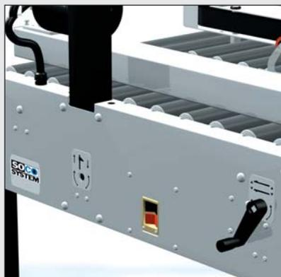
Manivelle permettant l'ajustement selon la taille des caisses
