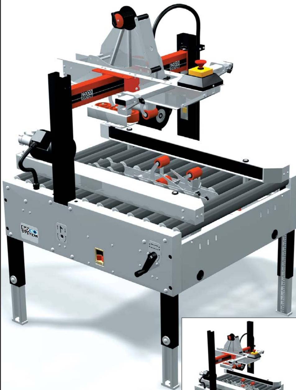
T-2000 Maxi avec colonnes rehaussées pour la manipulation de caisses carton de grandes tailles →
