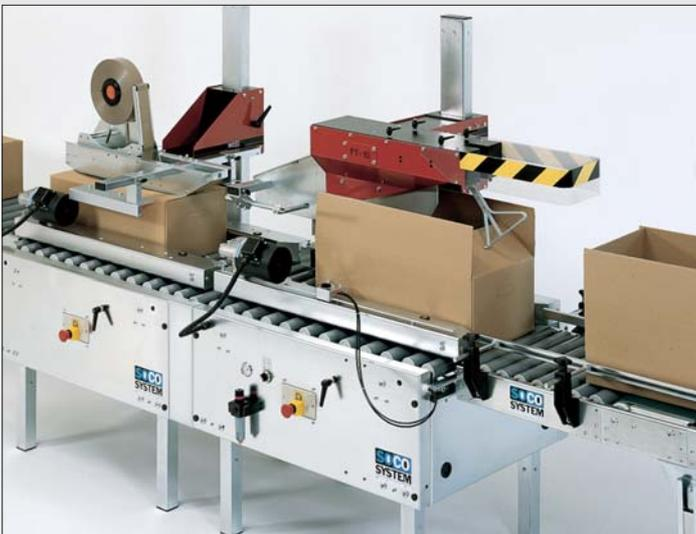
Le FT-10 est placé ici avant une machine à fermer les Caisses Carton T-10. Réunies, ces deux machines constituent une unité de production automatique pour la fermeture des cartons en séries de mêmes dimensions.
