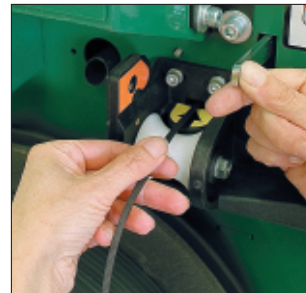
Insertion automatique L'intervention de l'opérateur se limite à insérer l'extrémité du lien, le remplissage de la machine et de l'accumulateur sont automatiques.
