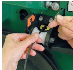
Insertion automatique L'intervention de l'opérateur se limite à insérer l'extrémité du lien, le remplissage du circuit et de l'accumulateur est automatique.
