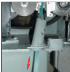
Coupe, éjection et relance automatique (A.C.R.) Pour une production sans arrêt.
