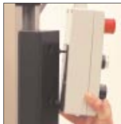
Boîtier amovible Un boîtier de commande amovible permet de choisir la position préférable de l'opérateur pour activer le cycle.
