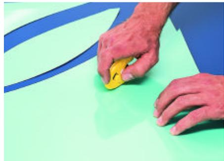
Ce coupe-papier et film en polystyrène résistant aux chocs, fonctionne sur le même principe que le COUPPY n° 43136. Le ressort en matière synthétique offre un avantage supplémentaire pour la coupe de matières  fines : il évite l'accumulation de matière devant le tranchant. Lame utilisable sur 4 côtés.
