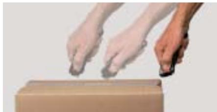
Idem, avec cependant une lame trapézoïdale. Pour la coupe de cartons triple cannelures. Le manche en matière plastique de forme ergonomique est équipé dans la zone de sortie de la lame d'un renfort métallique contre l'usure par frottement. Le curseur de la lame peut être actionné des deux côtés. Le couteau est ainsi utilisable aussi bien par les droitiers que par les gauchers. Le dispositif de sécurité agit systématiquement. Changement de lame rapide, sans accessoire. Label de sécurité GS.
