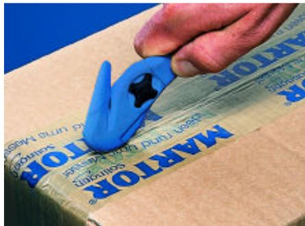
Idéal pour la coupe de bandes de matières synthétiques. Manche maniable en polystyrène résistant aux chocs. L'outil coupe les matières comme une paire de ciseau ouverte à 45°; la lame et le patin de protection forment exactement cet angle de 45°! Avantage: le tranchant est parfaitement protégé par la forme du manche! Lame utilisable sur 4 côtés.
