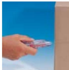
La force centrifuge générée en cas de dérapage du couteau, fait pivoter un balancier situé dans le manche, et libère ainsi l'action du ressort de rétraction: la lame disparaît automatiquement. Label de sécurité GS.
