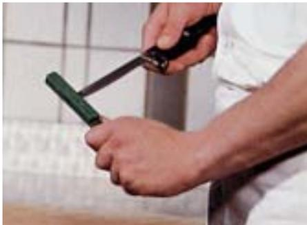
La pointe de la lame dépasse de la jauge; le couteau ne doit plus être utilisé pour désosser.
