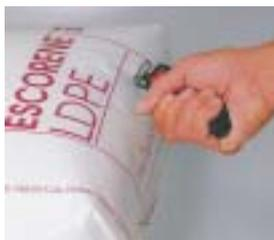
Du fait que ce n'est pas la lame, mais l'**étrier de protection qui est sous tension d'un ressort**, il est également possible de couper avec ULTRASAFE®, en toute sécurité, des matières ayant tendance à se dérober. Grâce à la **lame fixe**, il est même possible de couper en «sciant» (va et vient), car l'étrier ne se remet en position de repos que lorsque la lame sort effectivement de la matière coupée.
