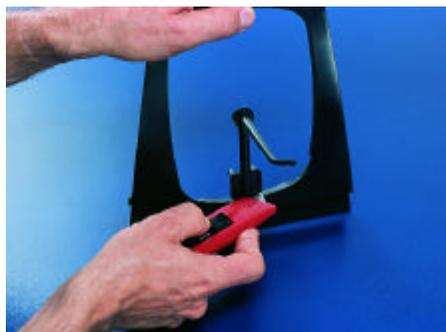
Pour droitiers. Couteau de sécurité, en polycarbonate résistant relativement aux frottements. La lame se rétracte automatiquement dans le manche, dès que le tranchant quitte le produit à couper, si le curseur n'est pas maintenu. Ôter le pouce du curseur pendant la coupe! Il est donc inutile de maintenir le curseur après l'amorce de la coupe. Usages: ébavurage et finition des pièces en matière synthétique injectée. Label de sécurité GS.
