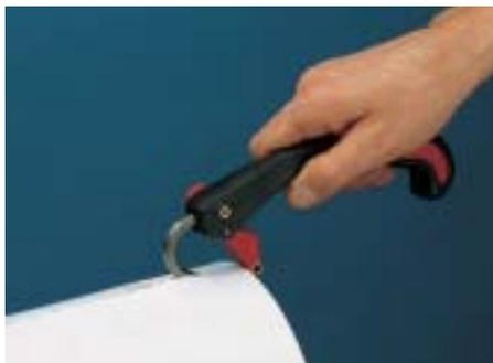
Dès que le crochet sort du papier, la protection revient automatiquement recouvrir la pointe.
