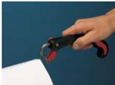
Manche en alliage de zinc coulé sous pression. Le protège-lame, monté sur ressort, se remet automatiquement devant le tranchant dès que le couteau quitte le produit à couper. La lame spéciale en acier trempé comporte le double de zones de coupe qu'une lame trapézoïdale. En retournant la plaquette rouge, elle peut, avec l'embout à 45°, recouvrir le tranchant. Label de sécurité GS.
