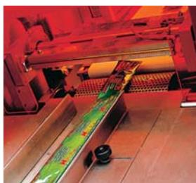
Le tube contenant les produits est achevé en continu et sans arrêt dans la zone de soudure transversale.
