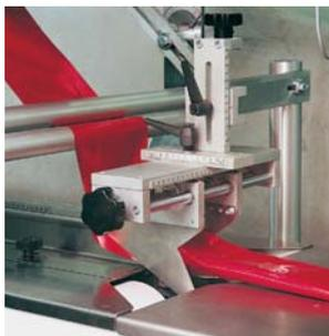
Deux possibilités existent pour l'arrivée du film : machine bobine haute, ou machine bobine base, cette dernière étant plutôt utilisée pour des produits difficiles à transporter ou dont le format n'est pas régulier, tels que des légumes frais, le film fait alors office de réceptacle et de bande de transport tout au long de la machine. Dans ce cas, les molettes de soudure sont positionnées en haut.
