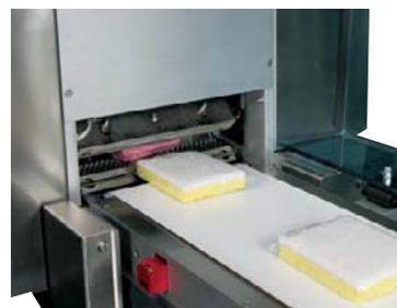
Le produit fini est évacué en sortie de machine par une bande transporteuse.
