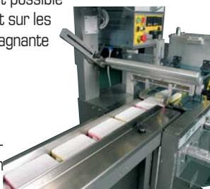
Un conformateur vient envelopper le film autour des produits qui vont les uns derrière les autres se retrouver dans un tube formé en continu par le film. Ce conformateur peut être fixe et dédié au format du produit, ou réglable pour s'adapter à une gamme de produits de section différente.
