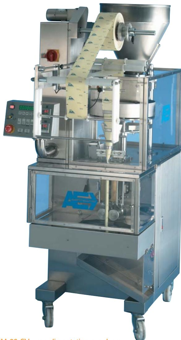
VM 03 SV avec alimentation par doseur volumétrique à quatre godets, réalisation de sachets 3 soudures.
