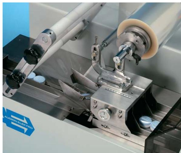
Détail du conformateur réglable. Pour faciliter les changements de formats, des conformateurs fixes peuvent être proposés
