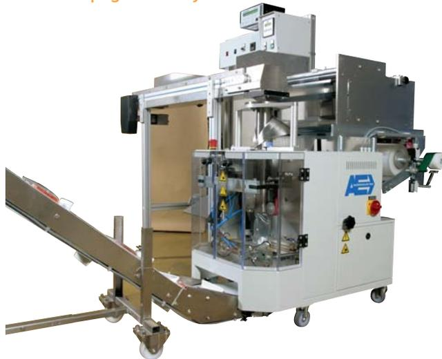
L'ensacheuse verticale AVM 190 IC d'une hauteur hors tout de 950 mm a été spécialement conçue pour être intégrée sous des postes de travail.
