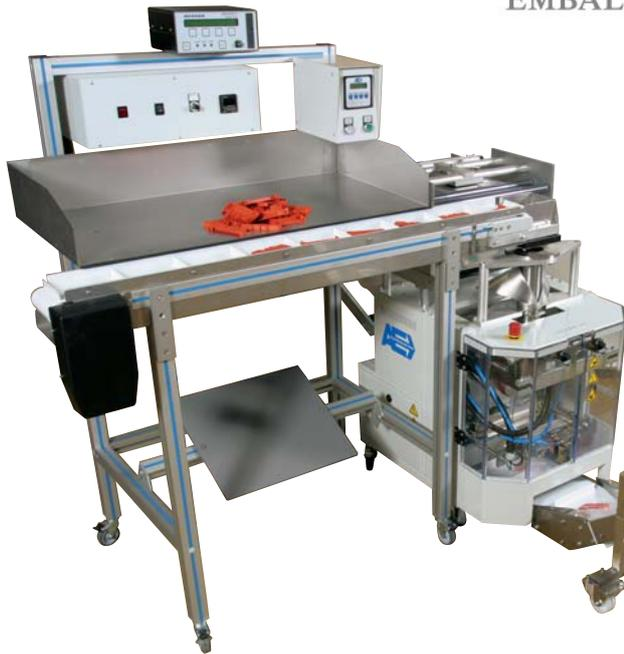
AVM 190 IC avec convoyeur d'alimentation, système de marquage et convoyeur d'évacuation
