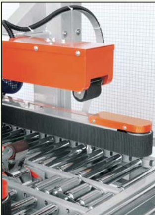
SENSORE INF./SUP. PER AUTODIMENSIONAMENTO SCATOLA IN AUTOMATICO
